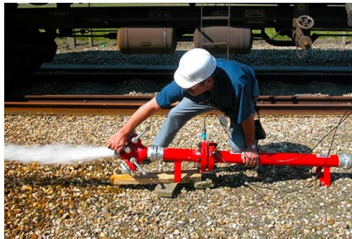
Фиг. 7. Проверка за дебит на сухотръбие на ж.п. перон.
