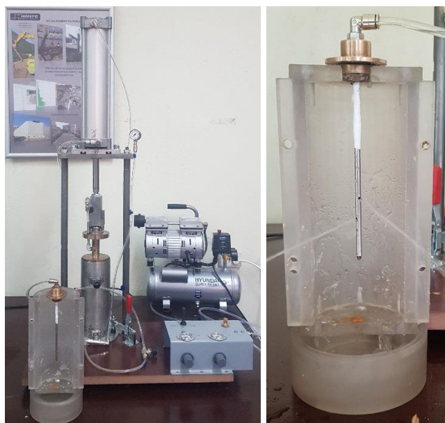
Фиг. 1. Апарат за лабораторно определяне инжектирането на разтвор в почвена проба
