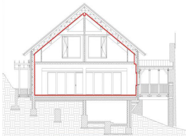
Фиг. 1.4. Контур на въздухонеплътния обем на пасивна къща с вентилатор (Blower door test)
