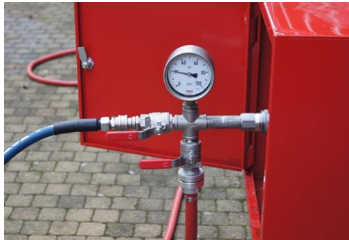
Фиг. 10. Петгодишна проверка на сухотръбието с вода под налягане.
